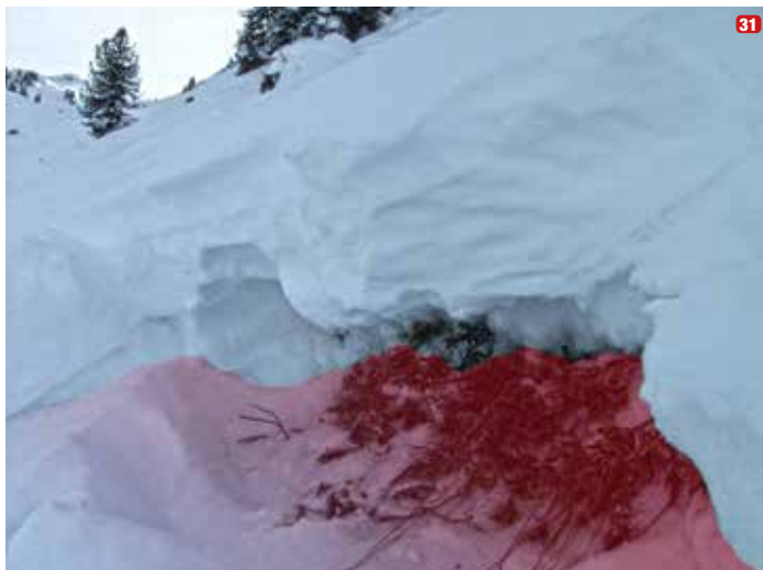
31 Der unter Windeinfluss gefallene Neuschnee lag auf einem schwachen Schwimmschneefundament. (Foto: LWD Tirol) | 32 Die Altschneedecke vom November hatte sich aufgrund des ungetrübten Schönwetters während der ersten Dezemberhälfte in kantige Kristalle und Schwimmschnee umgewandelt. Auf diesem schwachen Fundament kam der Neuschnee zu liegen, der ab dem 17.12. bei teils stürmischem Wind fiel. (Quelle: LWD Tirol) |
