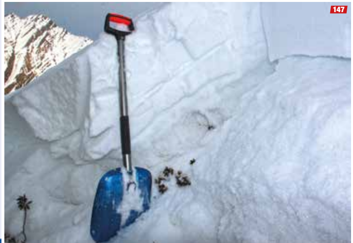
145 Schneeprofil. (Quelle: LWD Tirol) | 146 Blick von der 12 m tiefen Verschüttungsstelle nach oben. (Foto: LWD Tirol, 15.03.2017) | 147 Schneeprofil im Nahbereich der Auslösestelle. Die Schneehöhe ist dort eher unterdurchschnittlich. Man erkennt die grobkörnige, bodennahe Schwachschicht. (Foto: LWD Tirol, 15.03.2017) |
