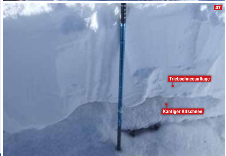
45 – 47 Das Schneeprofil und die Fotos zeigen die kombinierte Altschnee-Triebschnee-Problematik sehr anschaulich: Auf kantigem Altschnee (grieseliger „Zuckerschnee“) lagerte sich an den Tagen vor dem Unfall frischer Triebschnee ab (Windzeichen), der aufgrund dieser ungünstigen Unterlage leicht zu stören war. (Quelle: LWD Steiermark) |
