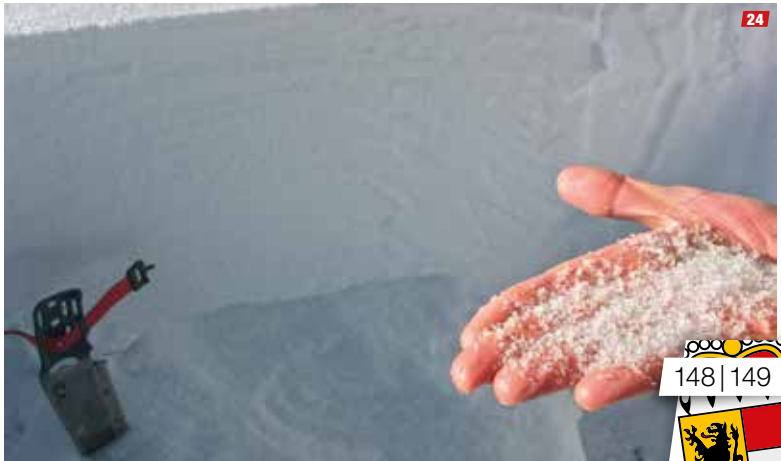
23 Profilstandort: Schneedeckenuntersuchung (Profil plus Stabilitätstest) im Randbereich, wo der Bruch durchging, aber wegen fehlender Steilheit und Geländeform nicht abging. (Foto: Bernhard Niedermoser) | 24 Die Schwachschicht: 5 cm dicke Schicht aus losen, großen Becherkristallen – wie Zucker – andere Bezeichnungen: Tiefenreif, Schwimmschnee, Becherschnee, Zuckerschnee. Eine solche gab es in den Hohen Tauern in diesen schneearmen, abgewehten Zonen unter den durch den Föhnsturm tragenden und festen Trieb- und Schneebrettschichten relativ verbreitet. (Foto: Bernhard Niedermoser) |
