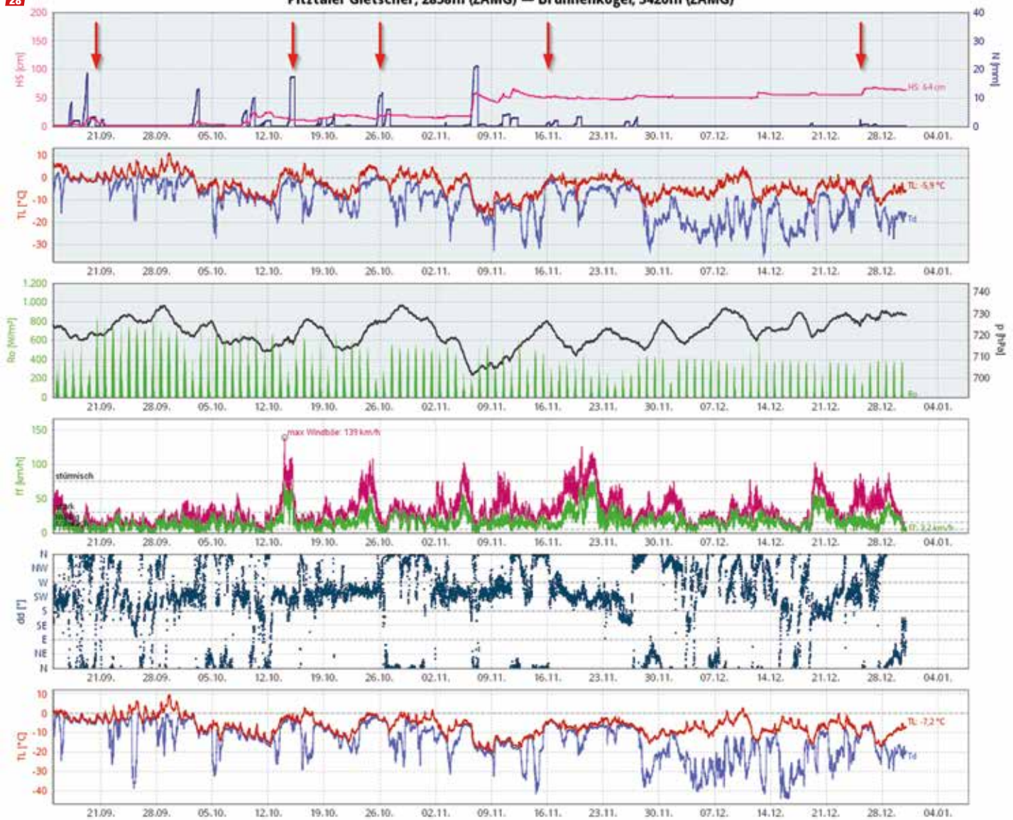
28 Die Pfeile kennzeichnen Zeitpunkte, ab denen sich bis Silvester 2016 Krusten und in der Folge bedeutsame Schwachschichten gebildet haben. (Quelle: LWD Tirol) |
