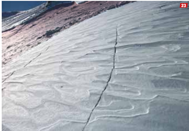
23 Profilstandort: Schneedeckenuntersuchung (Profil plus Stabilitätstest) im Randbereich, wo der Bruch durchging, aber wegen fehlender Steilheit und Geländeform nicht abging. (Foto: Bernhard Niedermoser) | 24 Die Schwachschicht: 5 cm dicke Schicht aus losen, großen Becherkristallen – wie Zucker – andere Bezeichnungen: Tiefenreif, Schwimmschnee, Becherschnee, Zuckerschnee. Eine solche gab es in den Hohen Tauern in diesen schneearmen, abgewehten Zonen unter den durch den Föhnsturm tragenden und festen Trieb- und Schneebrettschichten relativ verbreitet. (Foto: Bernhard Niedermoser) |
