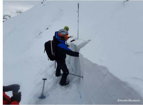
Abb. 3.23, links: an der Anrisskante aufgenommenes Schneeprofil. In der Schwachschicht aus kantigen Kristallen konnte beim Stabilitätstest beim 25. Schlag ein Bruch mit Fortpflanzung initiiert werden.
